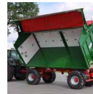
De hydraulisch openende zijwand
