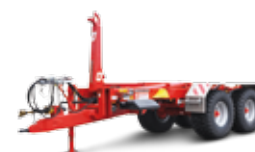
THL 20 (20 - 24 ton totaalgewicht, 16-20 ton optrekkracht)
