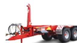
THL 20 (20 - 24 ton totaalgewicht, 16-20 ton optrekkracht)
