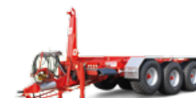
THL 30 (31 - 34 ton totaalgewicht, 30 ton optrekkracht)
