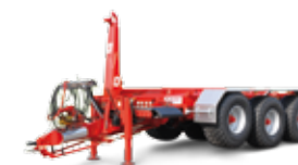
THL 30 (31 - 34 ton totaalgewicht, 30 ton optrekkracht)
