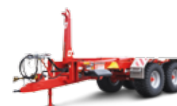
THL 20 (20 - 24 ton totaalgewicht, 16-20 ton optrekkracht)
